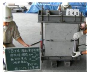
軸方向変位試験の状況
