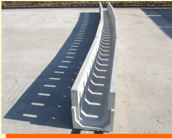
写真は、ジョイント部の隙間を20mm開けたときのカーブ付け状況（R = 50m 相当）
