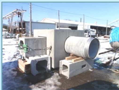
許容屈曲変位状態における水密性試験結果(ボックスカルバート 500×500)
