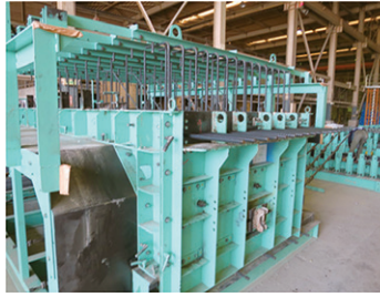
プレキャスト部材製作(頂版部材)
